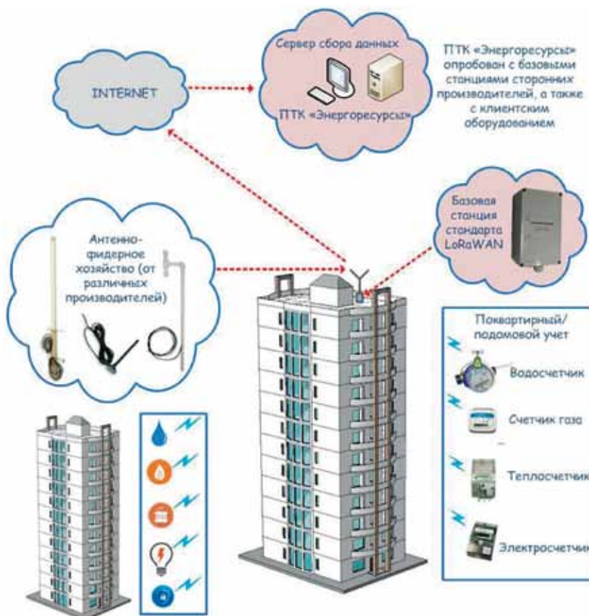
Рис. 1. Схема LoRaWAN-системы от компании «АРГО»
