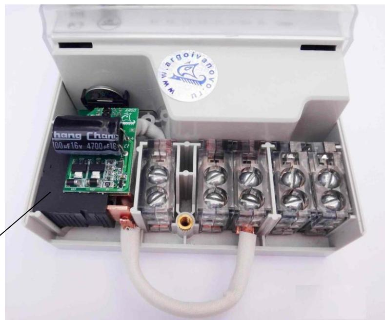
Рисунок 6 - установка реле ограничения потребления
