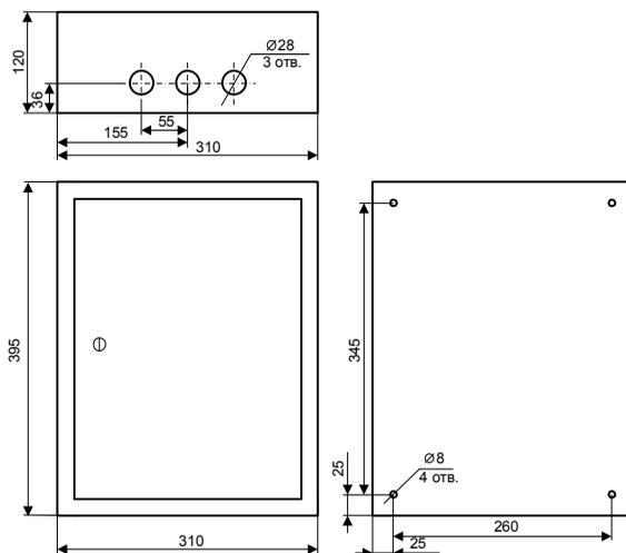
Рис. 1 Установочные размеры
