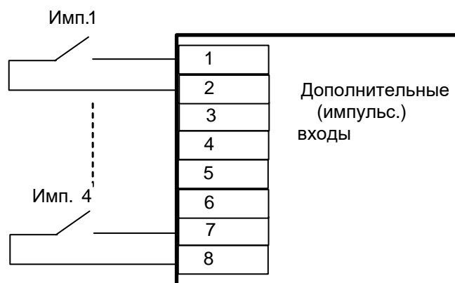
Рисунок 10 - схема подключения источников входных импульсных сигналов
