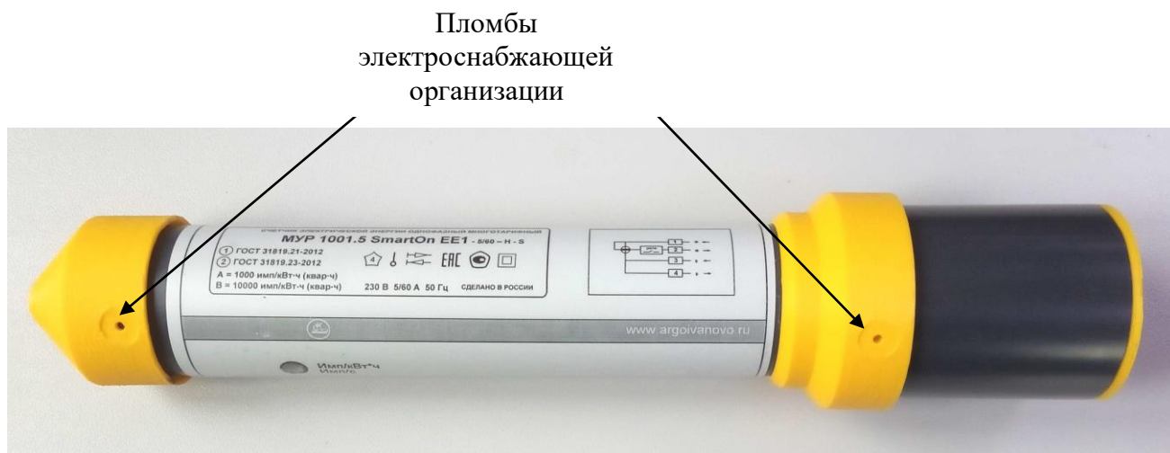
Рисунок 5 - внешний вид счетчика исполнения Split2 исполнения с местами нанесения пломб электроснабжающей организации
